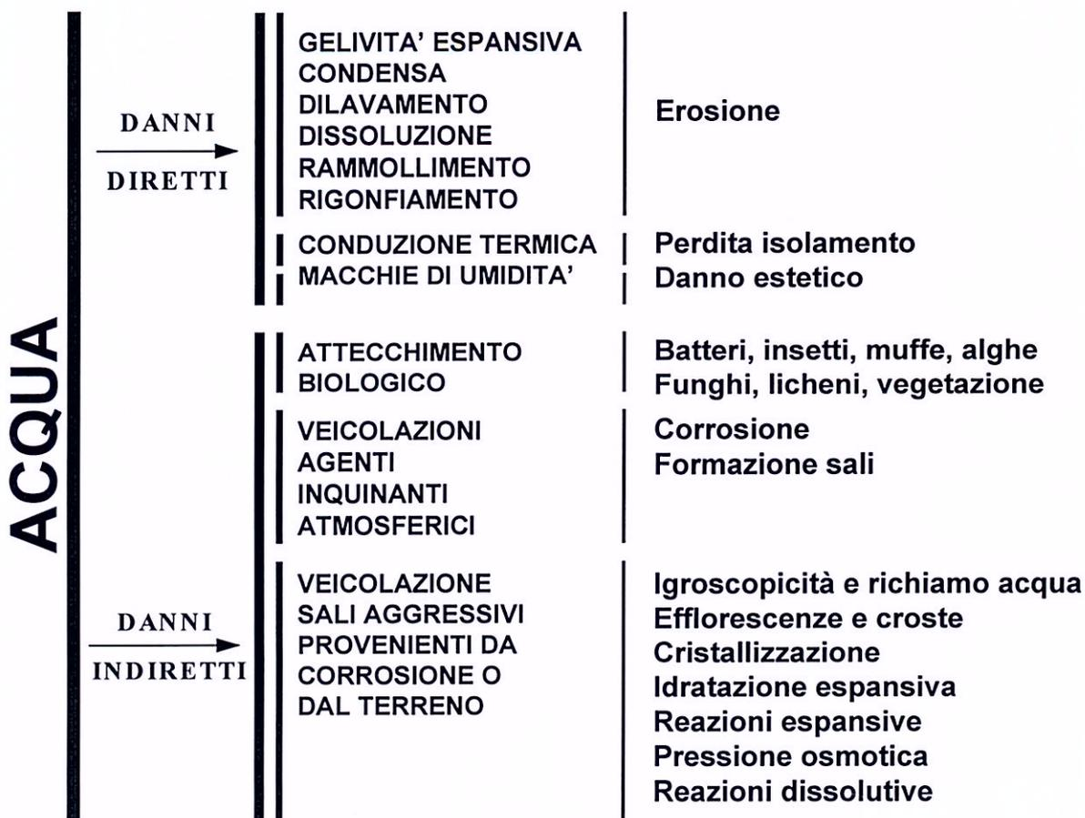
**Fig. N° 1 - Danni estetici e strutturali provocati dall'acqua e dall'umidità nel muro**
