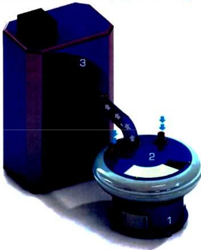
Per modificare il vostro impianto tradizionale ad umido, è sufficiente equipaggiare i **vibratori (1)** di un **coperchio (2)** appositamente ideato per la finitura a secco, e collegarlo con un **aspiratore (3)**.
