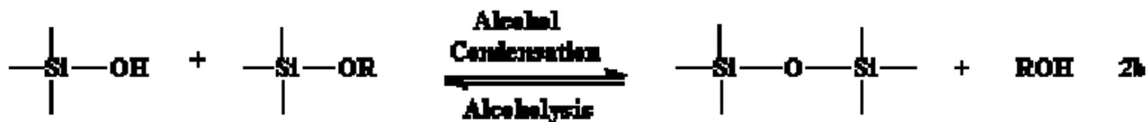
Durante il processo di invecchiamento la policondensazione continua portando ad una diminuzione della densità. La rimozione del solvente dai pori del reticolo porta alla formazione di uno Xerogel.
